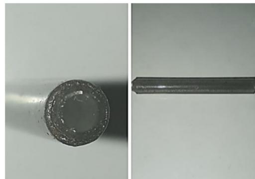
Gambar 2. *Tube* dengan material koposit (poliester + 2,5% serbuk Fe).
