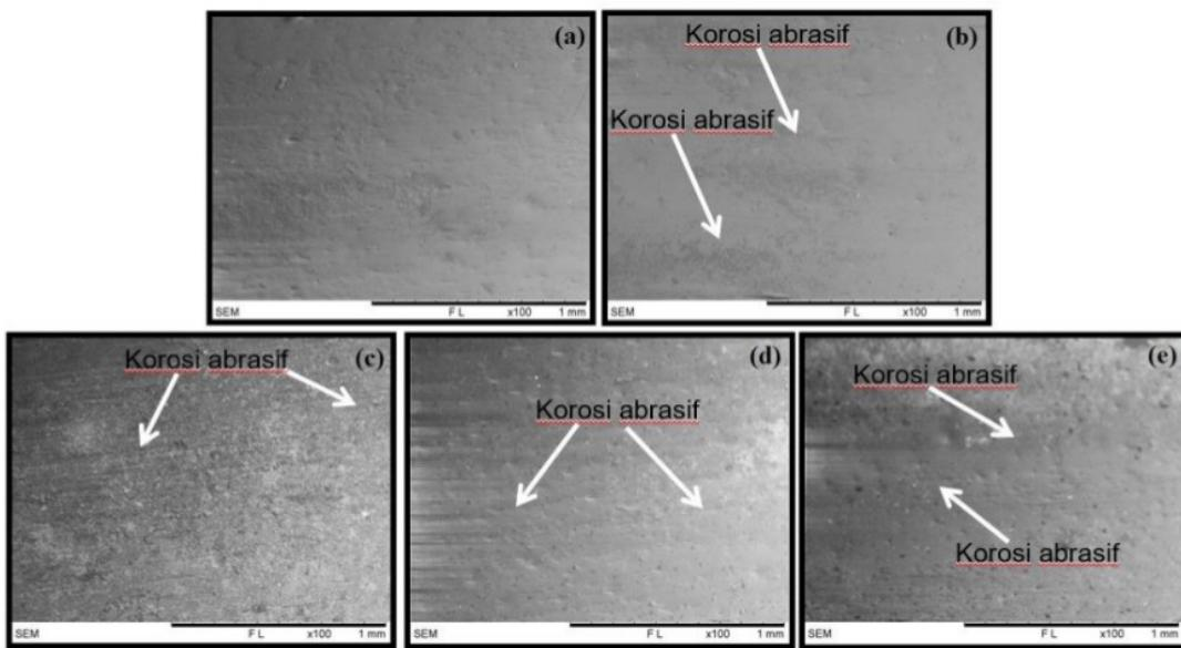
**Gambar 5.** Mikrograf SEM *tube* material poliester X100, (a) morfologi permukaan tanpa aliran urine (b) korosi abrasif setelah 1 minggu urine dialirkkan (c) korosi abrasif setelah 2 minggu urine dialirkkan (d) korosi abrasif setelah 3 minggu urine dialirkkan (e) korosi abrasif setelah 4 minggu urine dialirkkan
