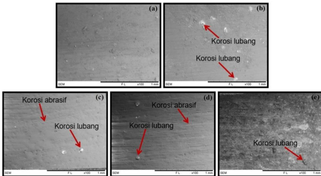
**Gambar 6.** Mikrograf SEM *tube* material koposit (poliester + 2,5% serbuk Fe) X100, (a) morfologi permukaan tanpa aliran urine (b) korosi lubang setelah 1 minggu urine dialirkkan (c) korosi abrasif dan korosi lubang setelah 2 minggu urine dialirkkan (d) korosi abrasif dan korosi lubang setelah 3 minggu urine dialirkkan (e) korosi lubang setelah 4 minggu urine dialirkkan
