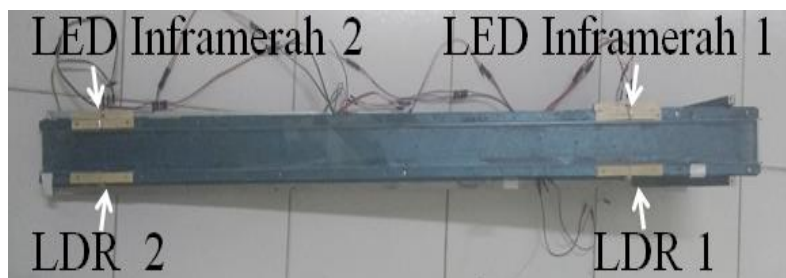
Gambar 2. Rangkaian sensor photogate 1 dan photogate 2 yang menggunakan LED inframerah sebagai pemancar dan light dependent resistor (LDR) sebagai penerima
